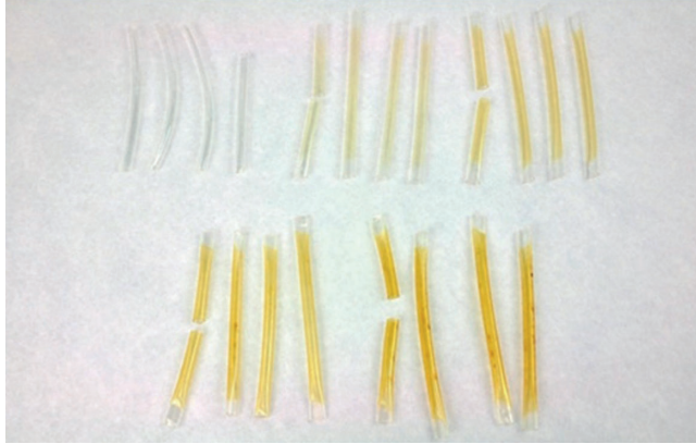
Bild 2. Ein mögliches Fehlerbild kann die Vergilbung medizinischer Schläuche aus Polyurethan sein [1]
