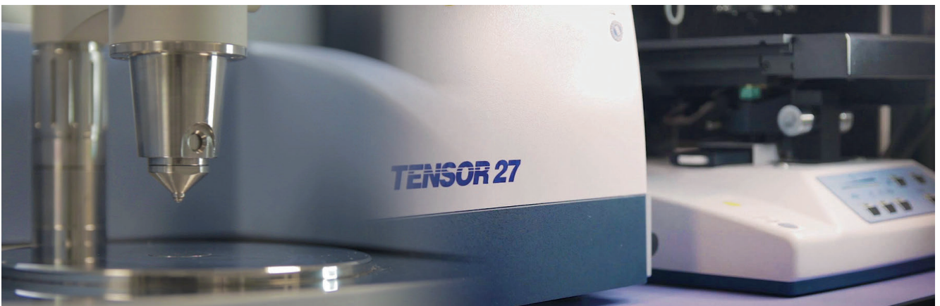
Die IR-Spektroskopie ist eine der gängigsten angewendeten Kunststoffprüfungen in der Schadensanalytik © Bruker
